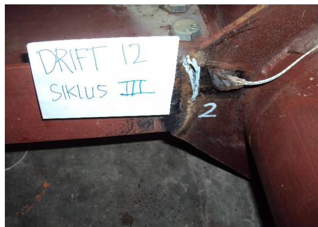
Gambar 11 Keruntuhan pada saat penurunan beban puncak BKD-K sisi atas
