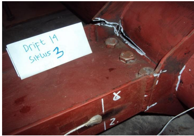
Gambar 9. Keruntuhan pada saat penurunan beban puncak BKD-T sisi atas
