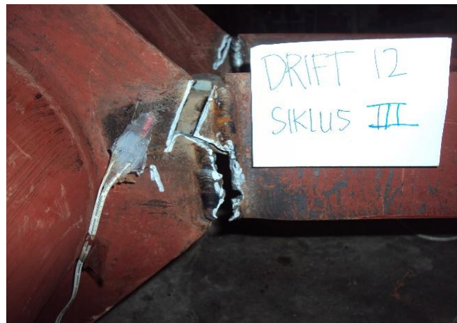
Gambar 10. Keruntuhan pada saat penurunan beban puncak BKD-K sisi bawah
