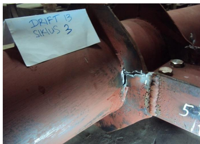
Gambar 8. Keruntuhan pada saat penurunan beban puncak BKD-T sisi bawah
