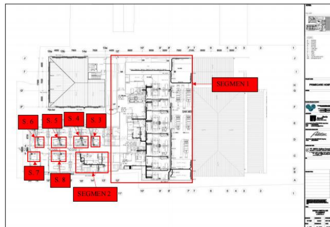
Gambar 4. Denah Instalasi Air Limbah Lantai 4
