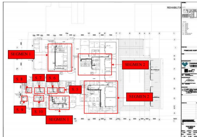
Gambar 3. Denah Instalasi Air Limbah Lantai 3
