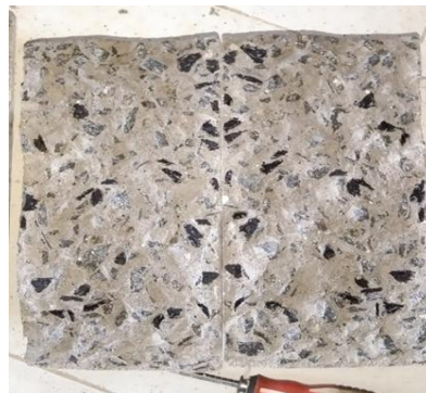
Gambar 8. Gambar tarik belah pasir sungai Lanrae 100%
